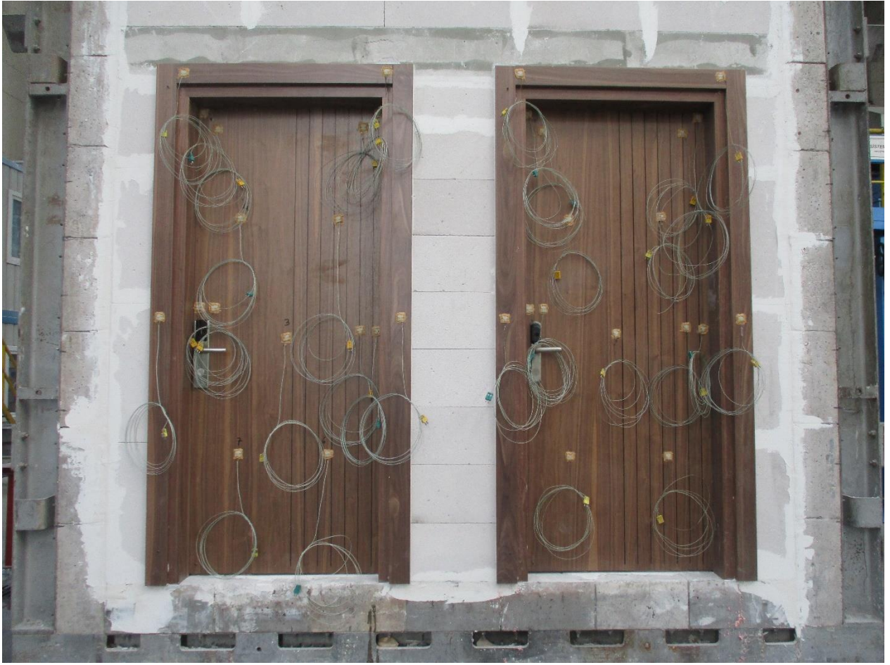
Fotoğraf C1: Test numunelerinin aleve maruz kalmayan yüzeyinin test öncesi görünümü
