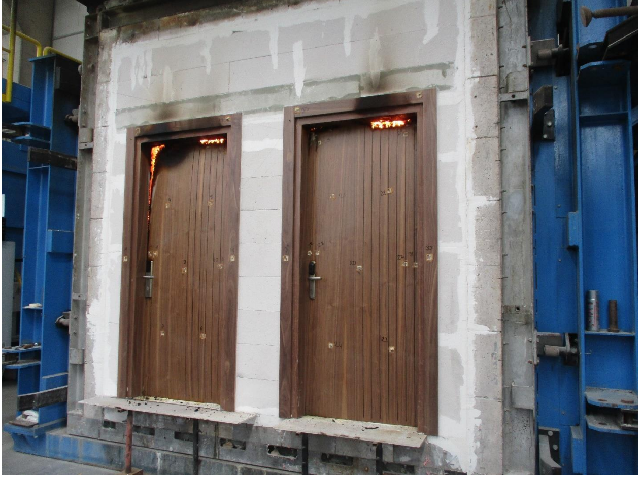
Fotoğraf C3: Test numunesinin aleve maruz kalmayan yüzeyinin test sonrası görünümü
