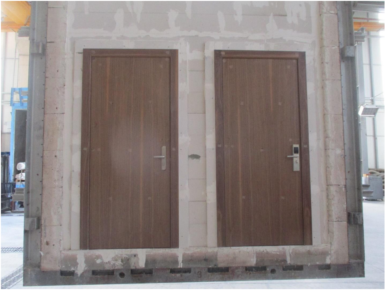
Fotoğraf C2: Test numunelerinin aleve maruz kalan yüzeyinin test öncesi görünümü
