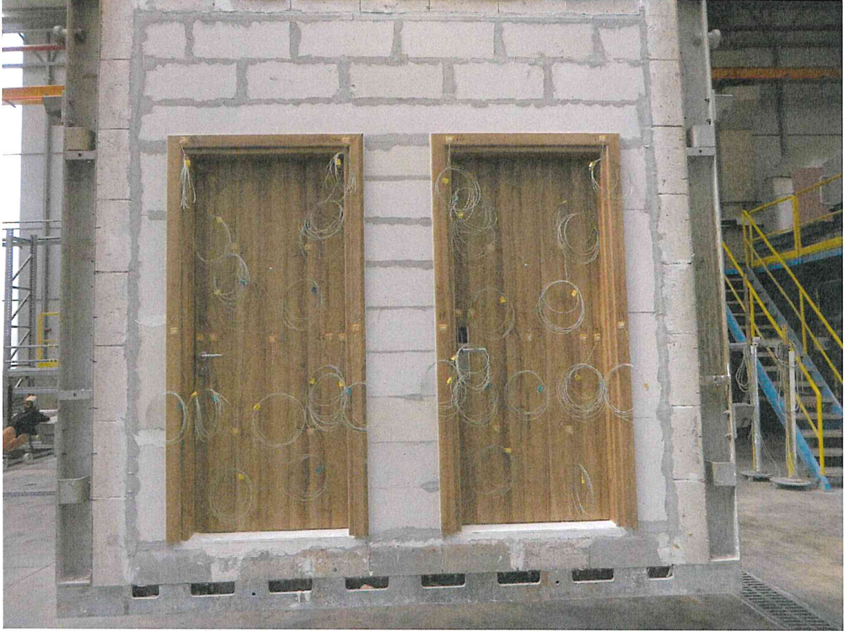
Resim C1: Kapı No.1 ve Kapı No.2'nin aleve maruz kalmayan yüzeyinin test öncesi görünümü.
